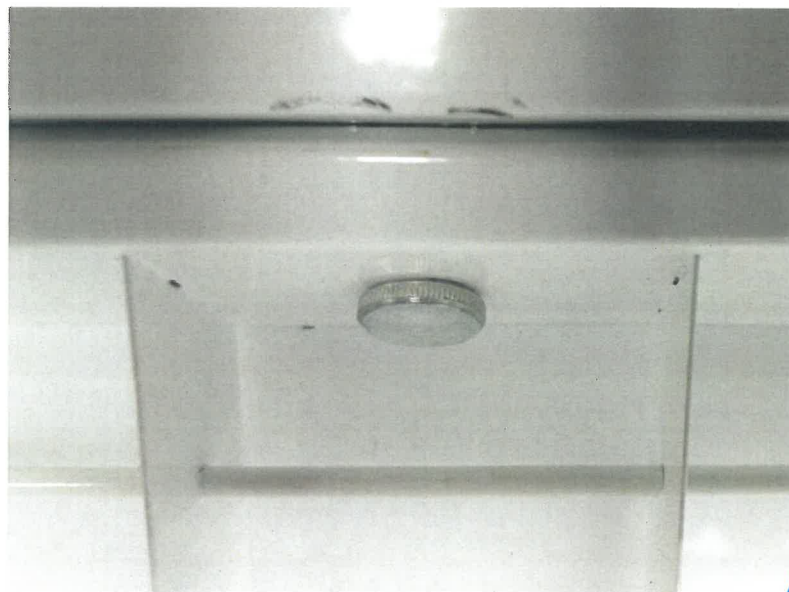
Bild 3: Schraube zur Befestigung des Rasters am Gehäuse (nach der Prüfung) Sporthallenleuchte „VB/PB Sport“
