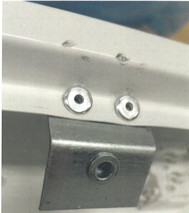
Bild 2: Befestigungsblech für Raster (nach der Prüfung) Sporthallenleuchte „VB/PB Sport“
